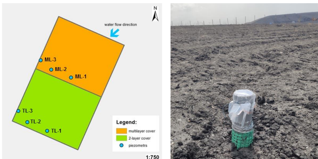
Rys. 30 Lokalizacja piezometrów na poligonie badawczym OUOW ZG Janina
